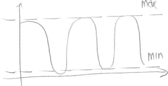
L'ampiezza dell'osc. dipende da  $S_{22}^1$  e  $S_{11}^2$ ; dobbiamo ridurre le oscillazioni, ma dunque adattare  $S_{22}^1$  e  $S_{11}^2$  ossia adattare i blocchi;
