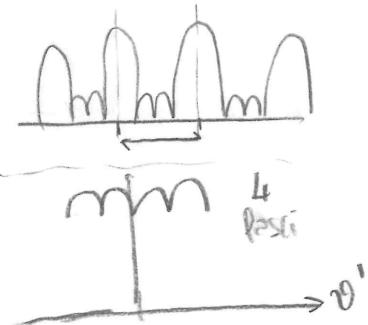
In questo modo (chiedendo  $\sin 45^\circ$ ) imponiamo che l'ultimo elemento sia  $+45^\circ$ .  $\Phi$  è il massimo sfasamento che si può fare; da  $-45^\circ$  a  $+45^\circ$  ci sono spazi di  $135^\circ$  con quei fasci.
