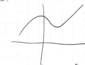
c'è un tratto in cui il prodotto  $v \cdot i$  è positivo. In questo tratto, il diodo "fornisce da generatore"; il ~~sistema~~ sistema è "localmente attivo" in quel tratto di caratteristica.  $v \cdot i > 0$
